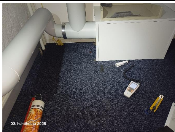
Kuva 26. Viiltomittaus tekstiilipalamaton alta.
