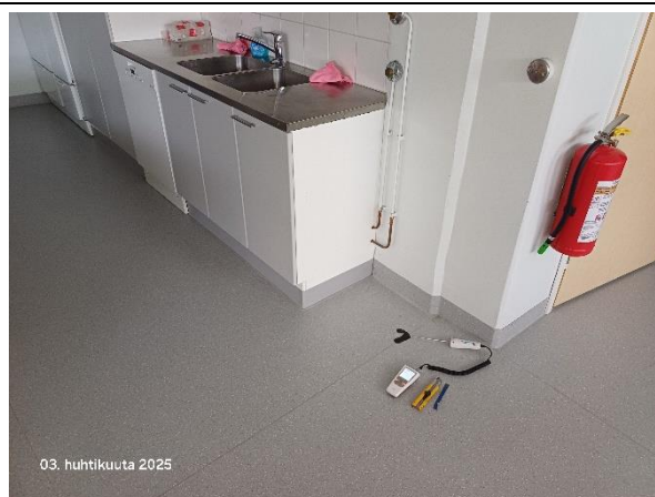
Kuva 28. Viiltomittaus kotitalousluokan pinnoitteena olevan muovimaton alta.
