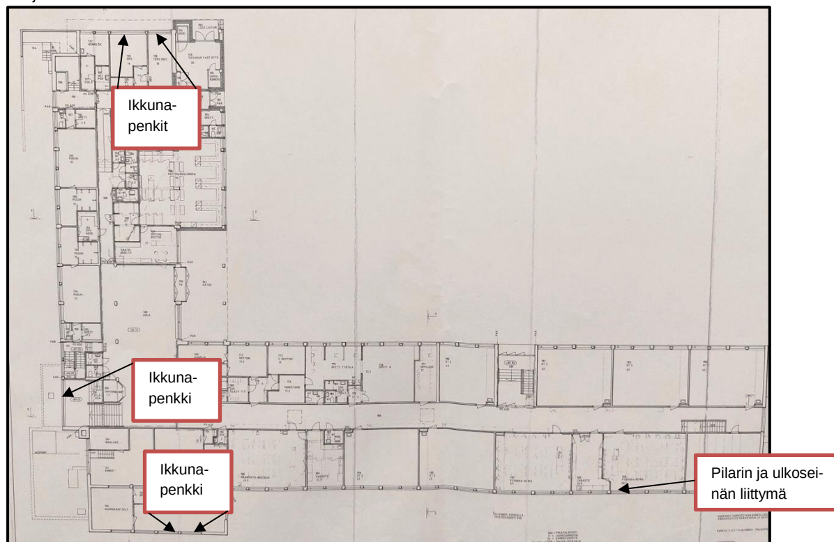
Pohjakuva 10. Havaitut ilmavuodot
